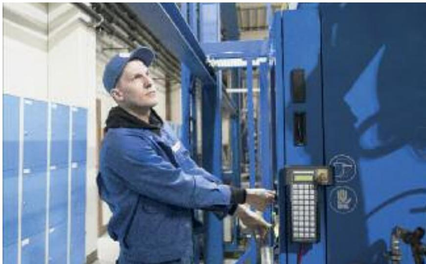
Ein Mitarbeiter der Röchling-Gruppe beim Anfahren einer Spritzgussmaschine nach einem Werkzeugwechsel
